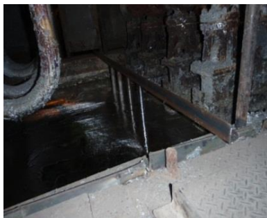
溶融亜鉛中への浸漬実験
