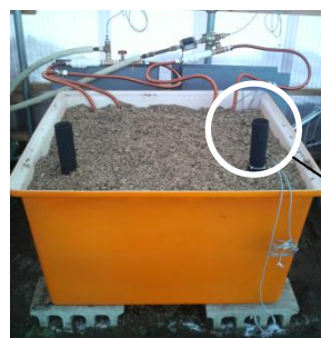
樹脂製容器と通気用樹脂製網状パイプ
