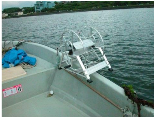
試作・提案したリール巻き上げ方式
