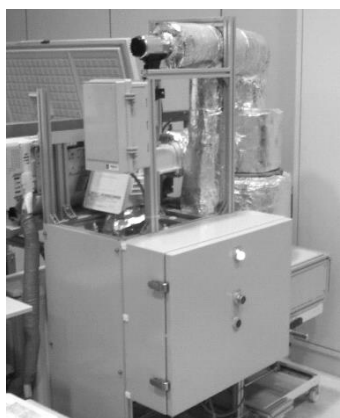
図1 ヒートポンプ式ベンチスケール乾燥装置 ヒートポンプ式乾燥装置利用実験における乾燥時間と減量率 (乾燥温度：70℃、ながいも処理量：2.5kg)
