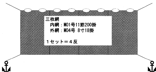
図2 調査漁具図（三枚網）
