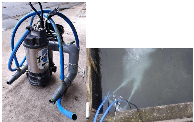
図 1. 水中ポンプを用いた酸素溶解機
