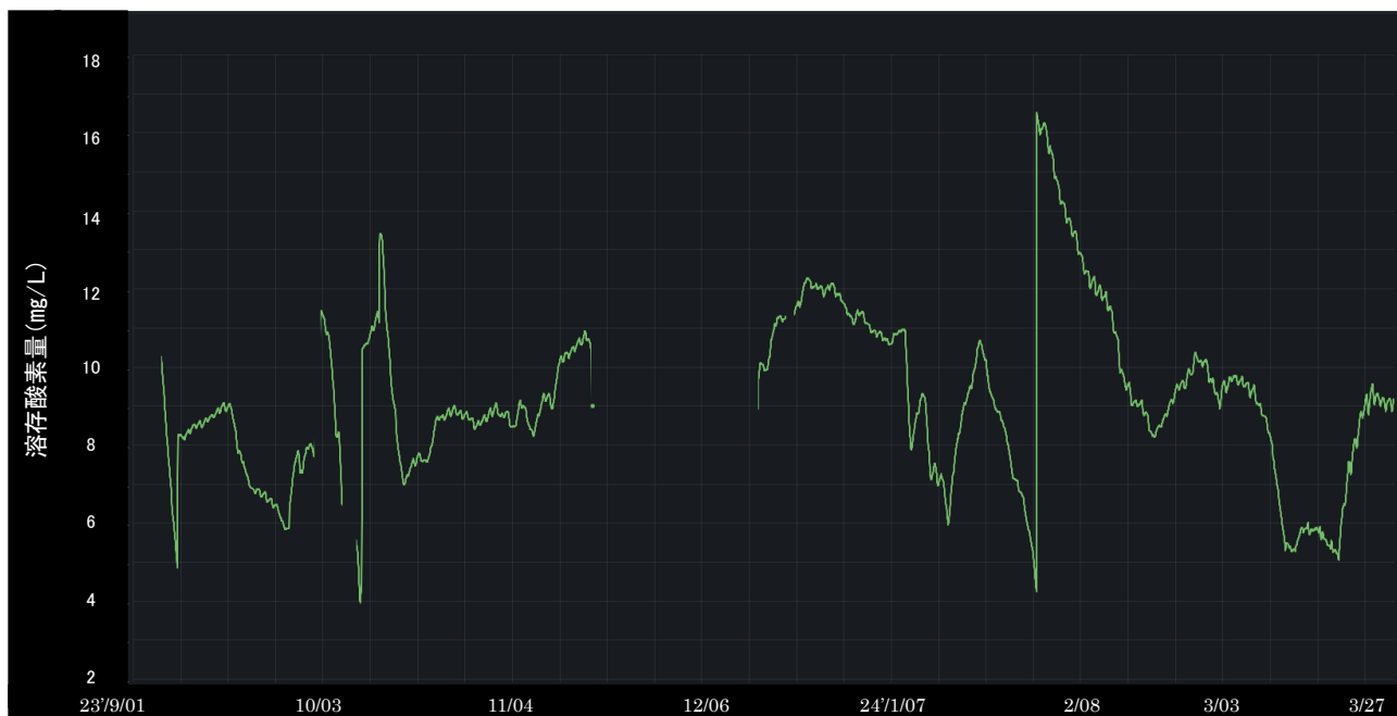
図 7. フィッシングパークのへじに設置した飼育環境モニタリングシステムによる溶存酸素量の推移
