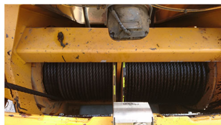
クレーン車のウインチ部
