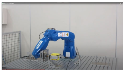
アーム型高速ロボットによる アルミ板の仕上げ加工
