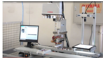
スカラ型ロボットによる チョコレート菓子の箱詰め
