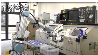
アーム型協働ロボットによる 工作機械へのワーク自動供給
