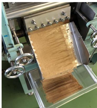
図1 ドラムドライヤーによる乾燥
