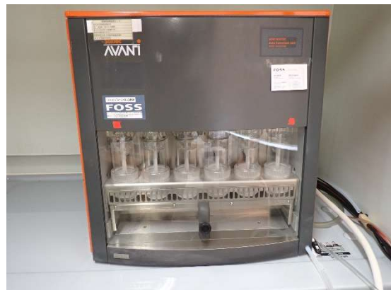
脂質の測定に使用するソックスレー抽出機
