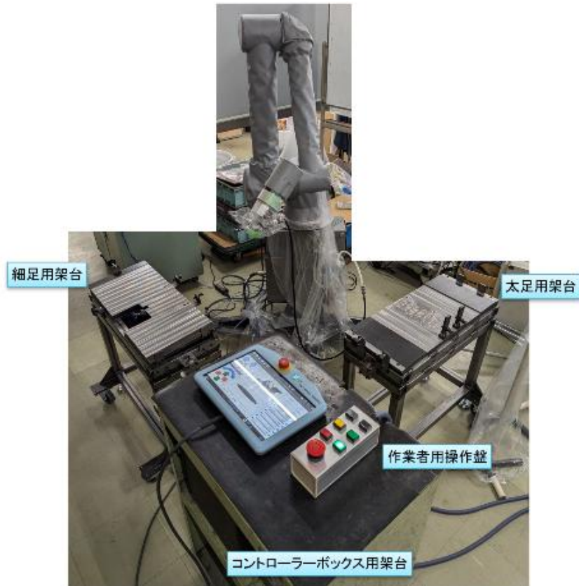
写真3 製品の加工に応用したバリ取りシステム全体像
