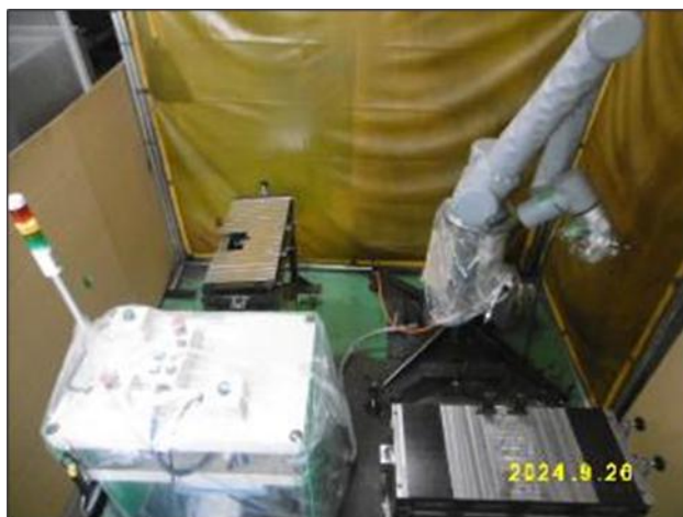
写真1 導入したバリ取りロボットシステム
