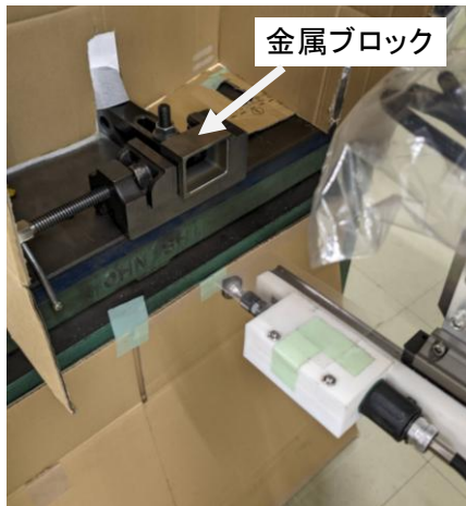
写真1 実験用金属ブロックにバリ取り加工
