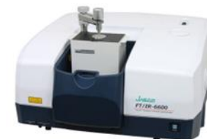
分光光度計装置(FT-IR:計測部本体)
