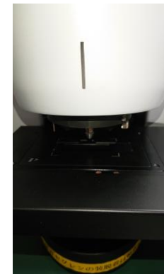
顕微モードで使用する計測ユニット
