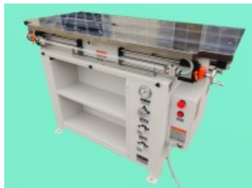
フルフラット横型バンダー 変形量計測 ※出典 (有)カワサキ機工様のホームページから
