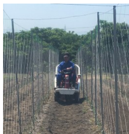
広畝栽培で中耕作業を行う幅狭トラクタ
