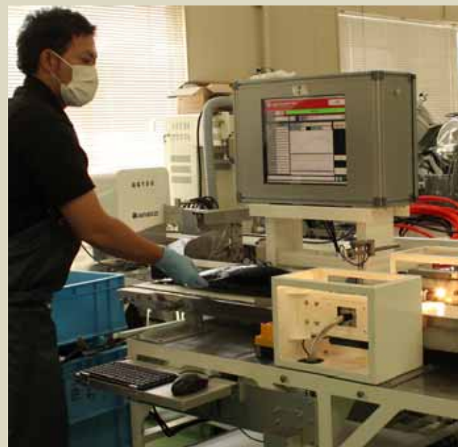
図 光センシングによる水産物の脂質測定
