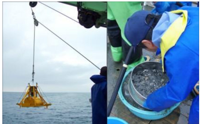
漁業公害調査指導事業における陸奥湾の底質調査 (左側：採泥器、右側：採取した底泥の処理)
