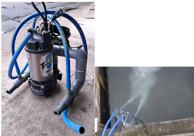
図3. 水中ポンプを用いた酸素溶解機
