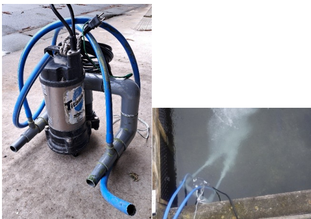
図3. 水中ポンプを用いた酸素溶解機
