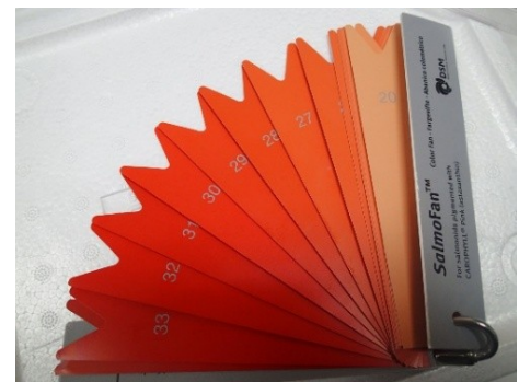
図2. サーモン肉色判別用カラーチャート DSM社のSalmo Fan TM
