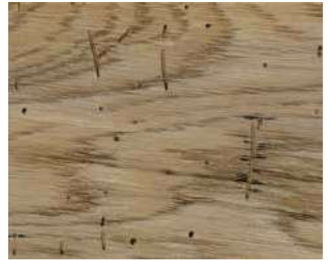
丸太をかつらむきした単板(虫穴部分を拡大)
