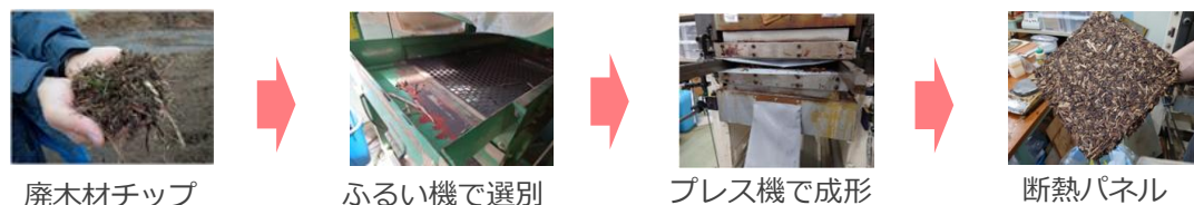
図 3 木チップパネルの製造工程
