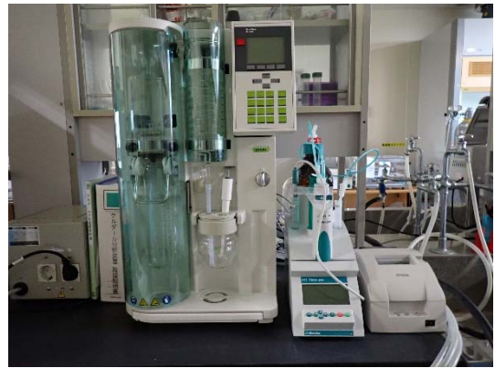
タンパク質を測定するケルダール蒸留・滴定装置
