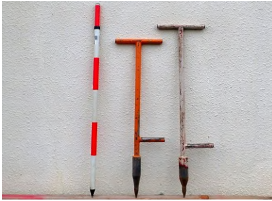
写真4 コンテナ苗植付穴あけ器具ディブル （左:150cc用、右:300cc用）
