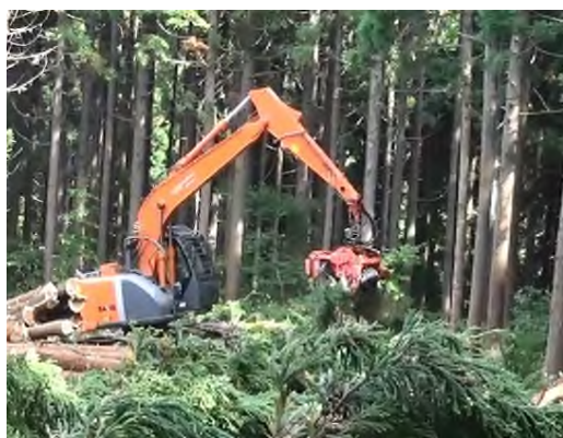
写真11 プロセッサによる機械地拵え実施状況
