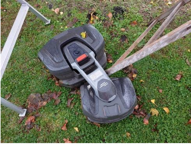
図7 AUTOMOWER 435X AWD が脚立を挟み込み エラー停止した状態
