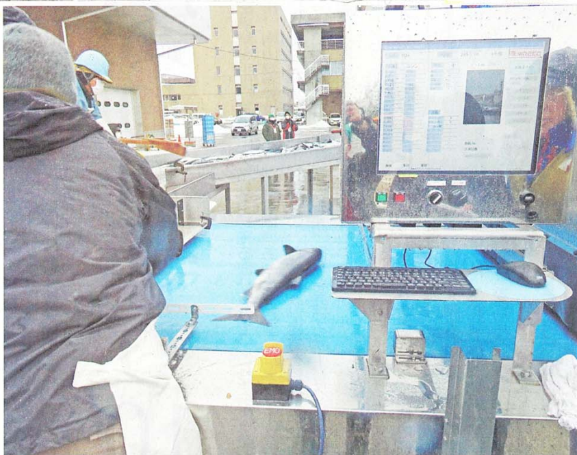
定置網で取れた魚を自動選別する装置の実証試験 14日、八戸市第3魚市場B棟前岸壁
