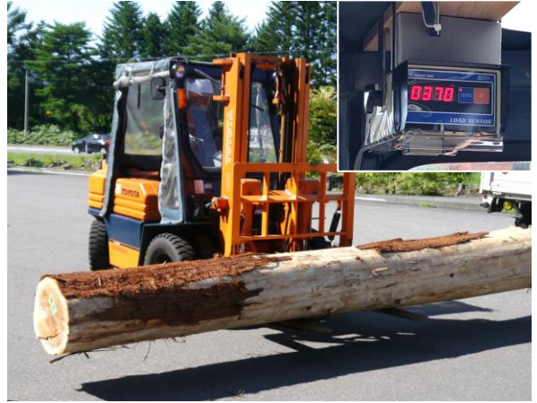
写真4 フォークリフト荷重計による測定 (右上：装着した荷重計)
