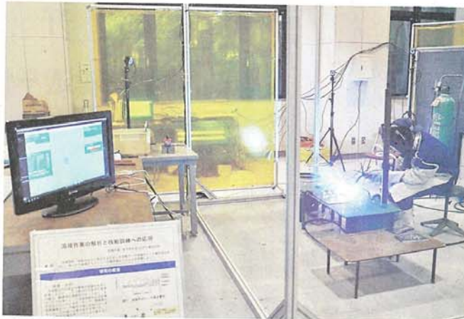
モーションキャプチャを利用した溶接の訓練用システム
