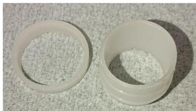
リングと本体の間にppフィルムを張り、試料を宙刷りにする
