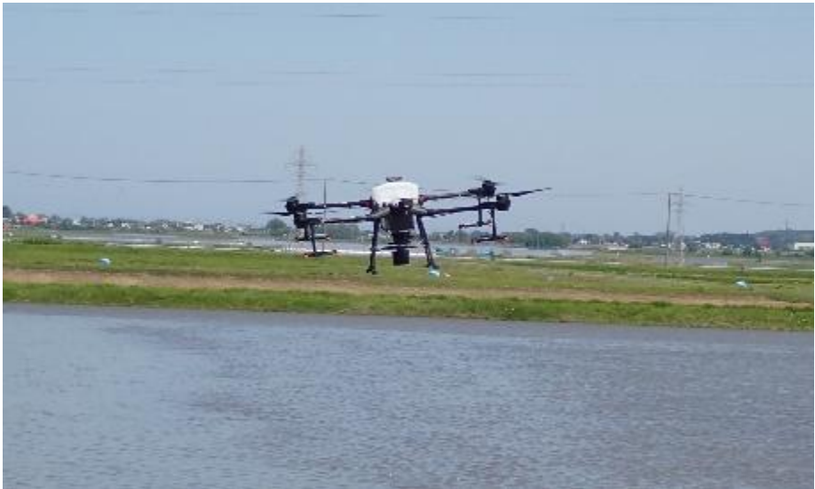
図3-11 Agras T20での「豆つぶ剤」の散布の様子
