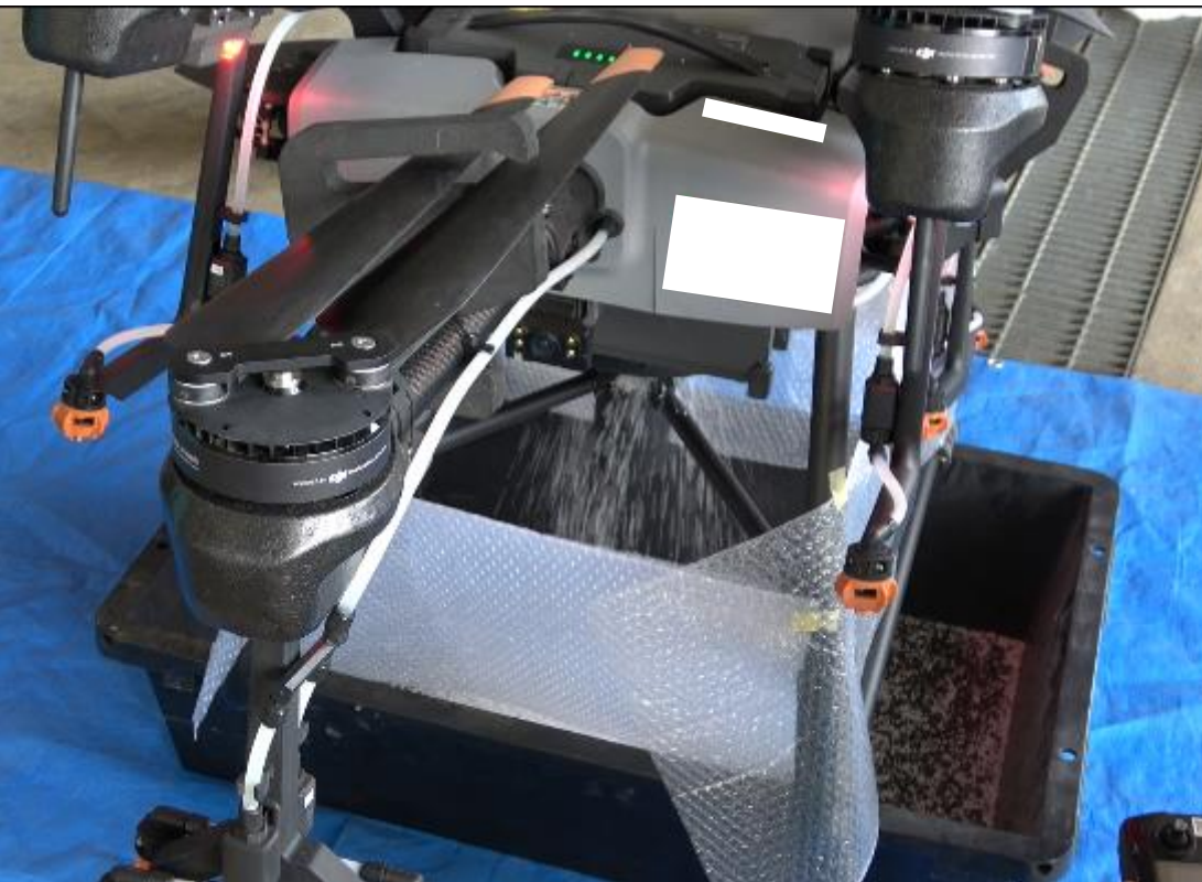
図3-28 シャッター開度の確認の様子
