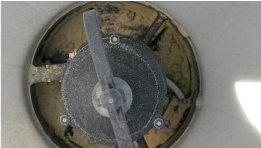
図3-16 Agras T10で散布した後の薬剤タンク シャッター付近に粉状になった「豆つぶ剤」が残る
