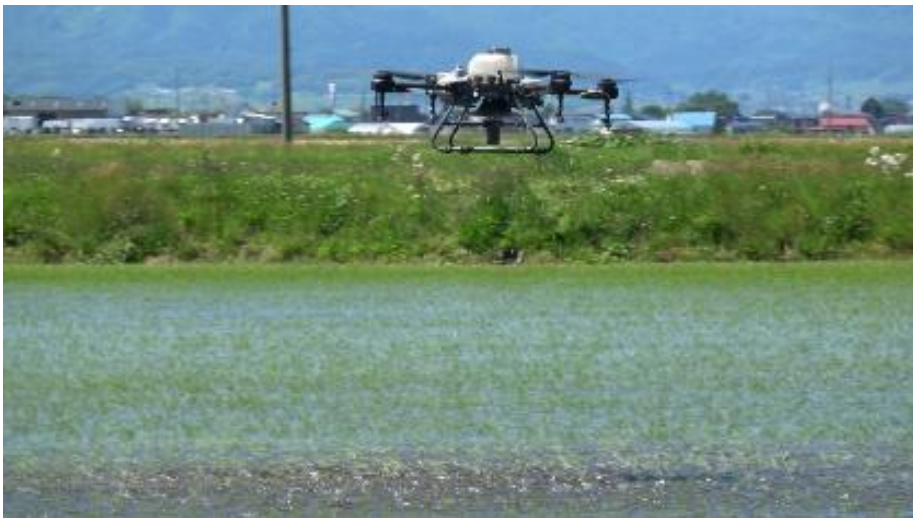
図3-18 Agras T10での 「豆つぶ剤」の散布の様子
