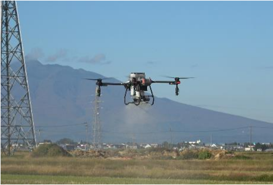
図3-31 Agras T50での稲わら分解資材の散布の様子
