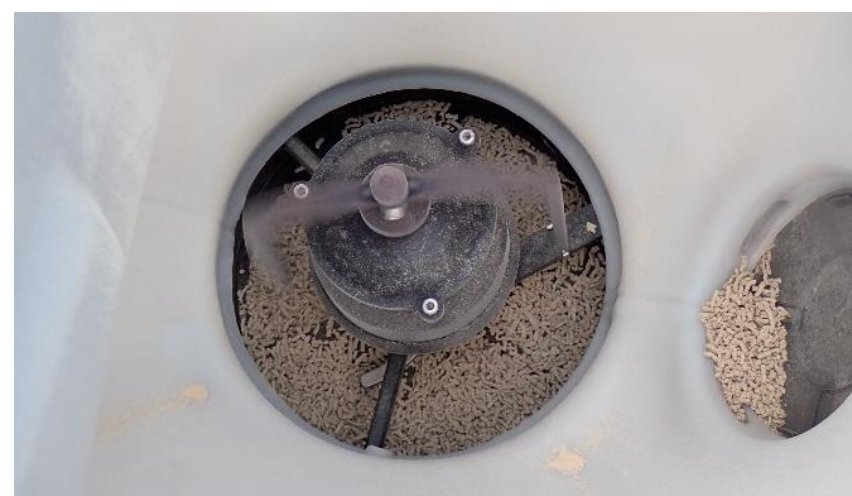
図3-13 Agras T25で散布した後の薬剤タンク シャッター付近に「FG剤」が残る ※写真はセンメツZ200FG散布後の様子
