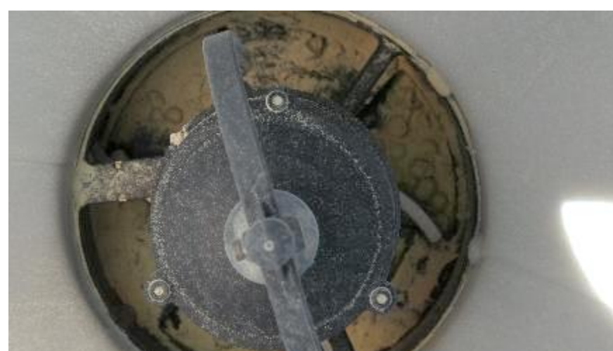
図3-6 Agras T10で散布した後の薬剤タンク シャッター付近に粉状になった「豆つぶ剤」が残る
