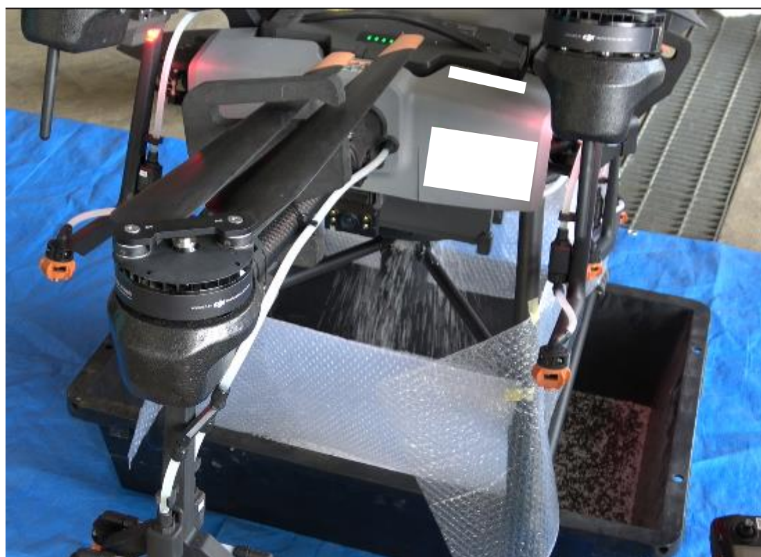
図3-19 シャッター開度の確認の様子
