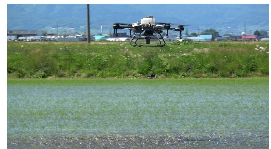
図22 Agras T10での「豆つぶ剤」の散布の様子
