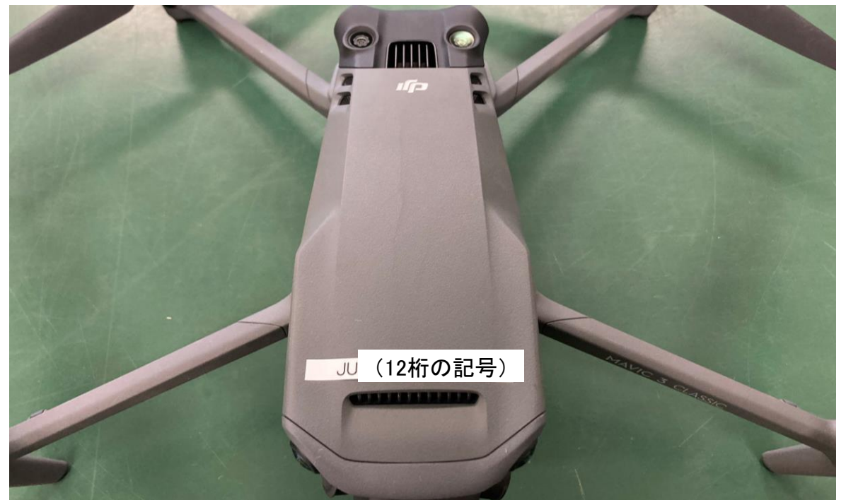
図2 ドローンの登録記号の表示例
