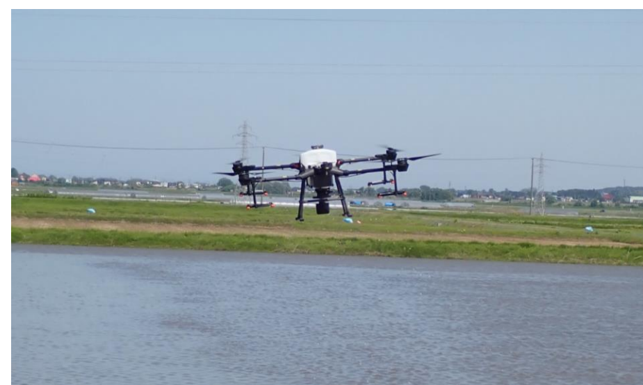
図13 Agras T20での「豆つぶ剤」の散布の様子
