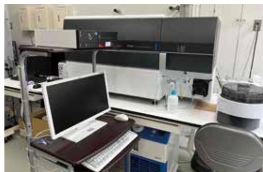
高感度で元素を測定する 「ICP発光分光分析装置」
