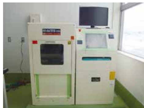
コンクリートの圧縮強度試験には 現在も対応している
