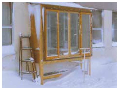
木製サッシの開発研究「自然環境試験」(1986年)
