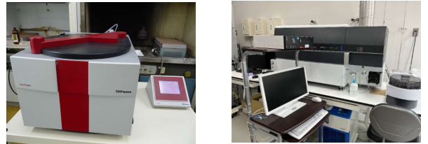
写真 マイクロウェーブ分解装置（左）及びICP発光分光分析装置（右）
