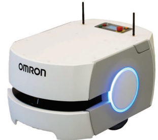
オムロン製 LD-90 (積載 90 kg, 移動速度 4.8 km/h)
