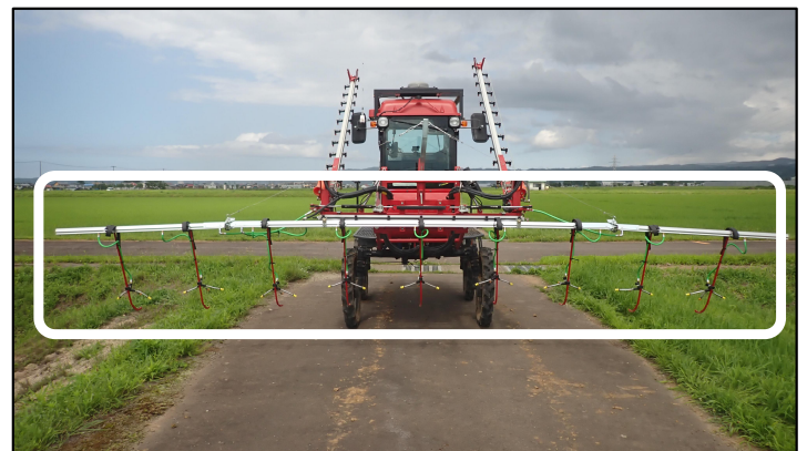
ハイクリブームに取付けた吊り下げノズル（白枠）
