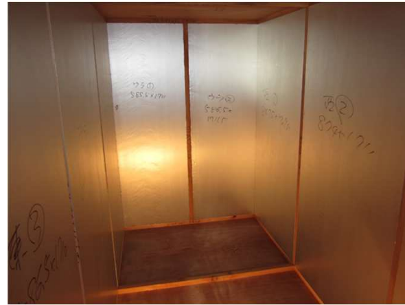
外は木材、中は断熱材で構築
