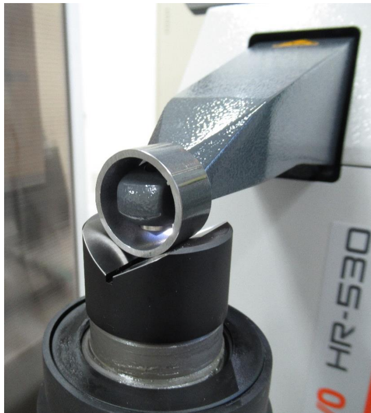
円筒内壁の測定例 (最小φ22mmまで)
