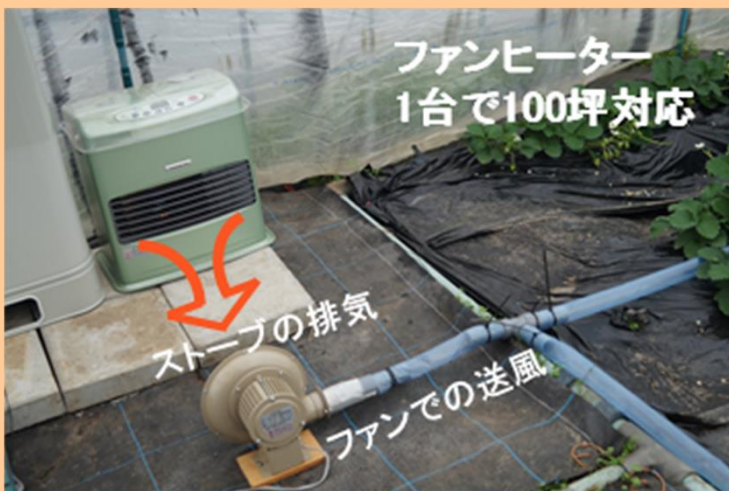
灯油ファンヒーターによるCO 2 施用方法（ほ場写真と模式図）
