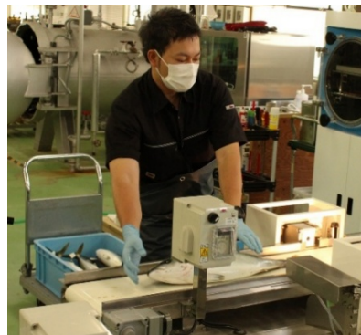
光センシング装置で魚の脂乗りを測定する木村主任研究員
