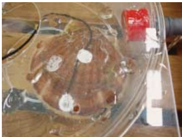
図1 センサーを取り付けたホタテガイ
